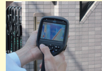
湿度の異常を感知し、赤く反応します
